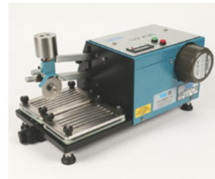
A atualização EN388:2016 dá a opção de manter esse teste de corte ou de testar as luvas através do ensaio ISO 13997, padrão que utiliza uma máquina chamada TDM-100.
