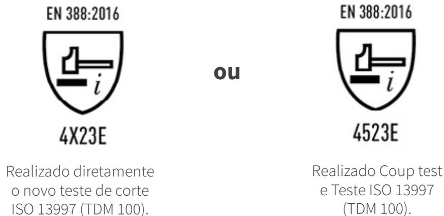
Quando a luva não apresentar como característica principal a resistência ao corte, poderá utilizar apenas o ensaio Coup Test, não ensaiando a luva no Teste ISO 13997 (TDM 100).
